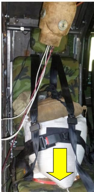
**Рис. 7.** Размещение датчика ускорения
