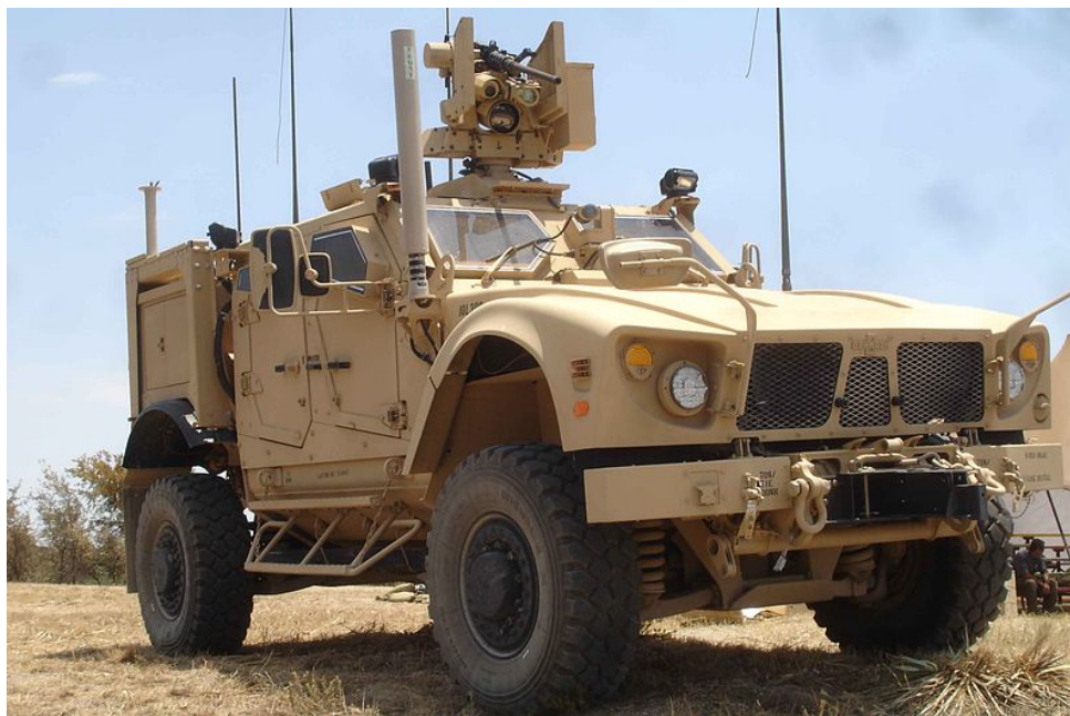
Рис. 9. MRAP легкого класса Oshkosh M-ATV с подвеской ТАК-4
