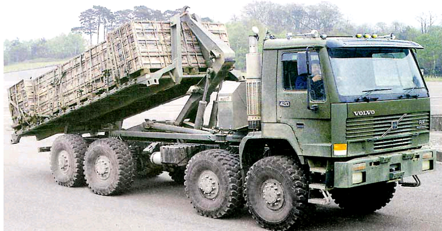
Рис. 14. Volvo FL12 8×8 с независимой рычажно-пружинной подвеской Timoney
