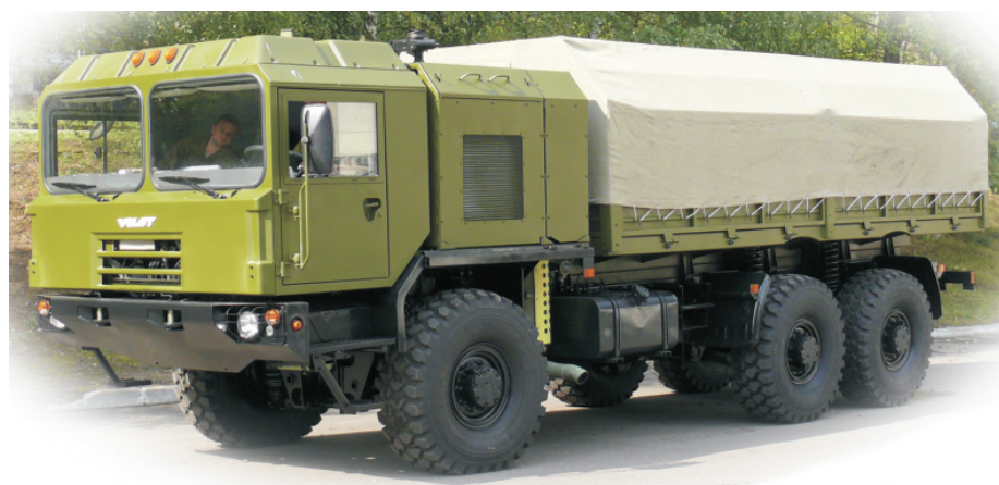
Рис. 16. Колесное шасси 6×6 МЗКТ-600100
