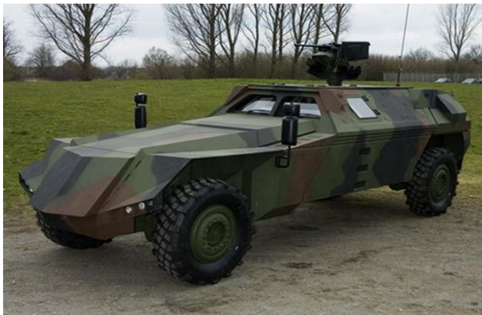
Рис. 13. Экспериментальная многоцелевая защищенная машина GEFAS с независимой двухрычажной подвеской Timoney
