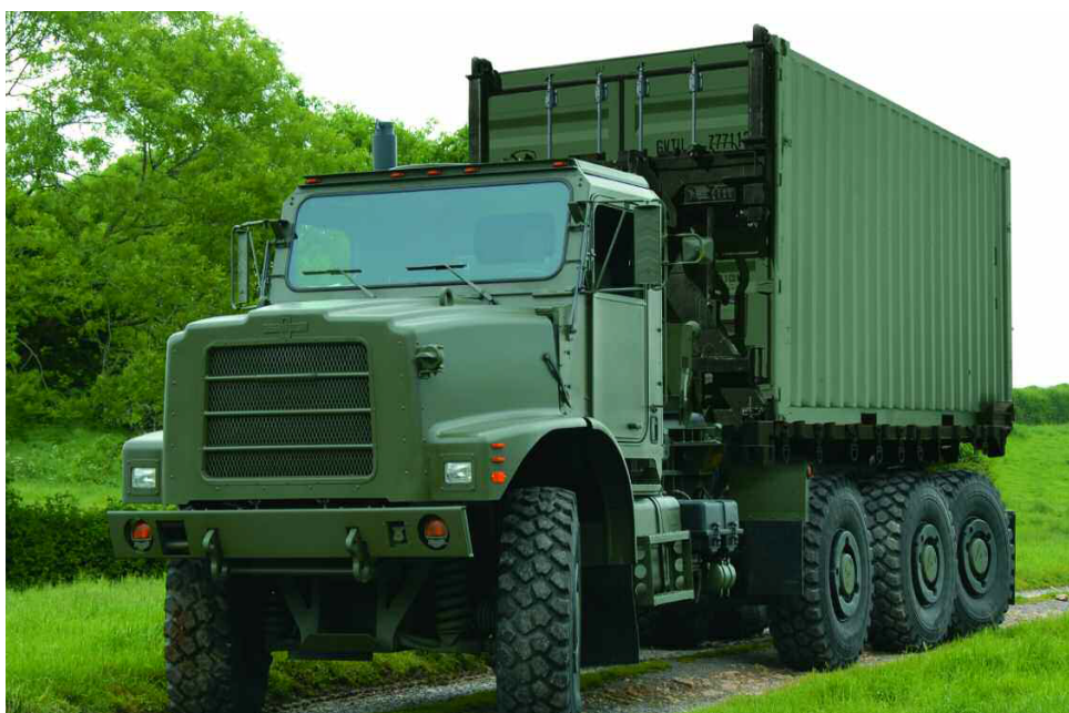
Рис. 6. 16,5-т контейнеровоз LHS 8×8 семейства Oshkosh MTRV с управляемыми колесами на 1, 3 и 4-м мостах
